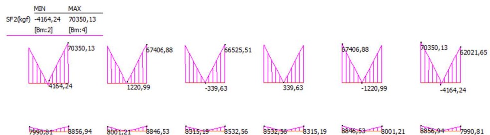
Figura 10.17 - Andamento diagramma di taglio V_{ed} SLU [kg/m]
