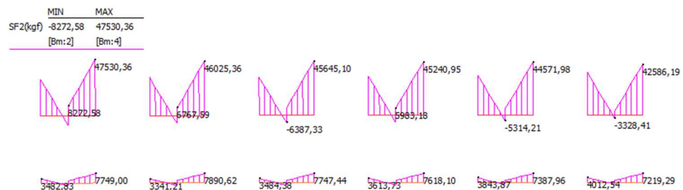
Figura 10.17 - Andamento diagramma di taglio V_{ed} SLU [kg/m]
