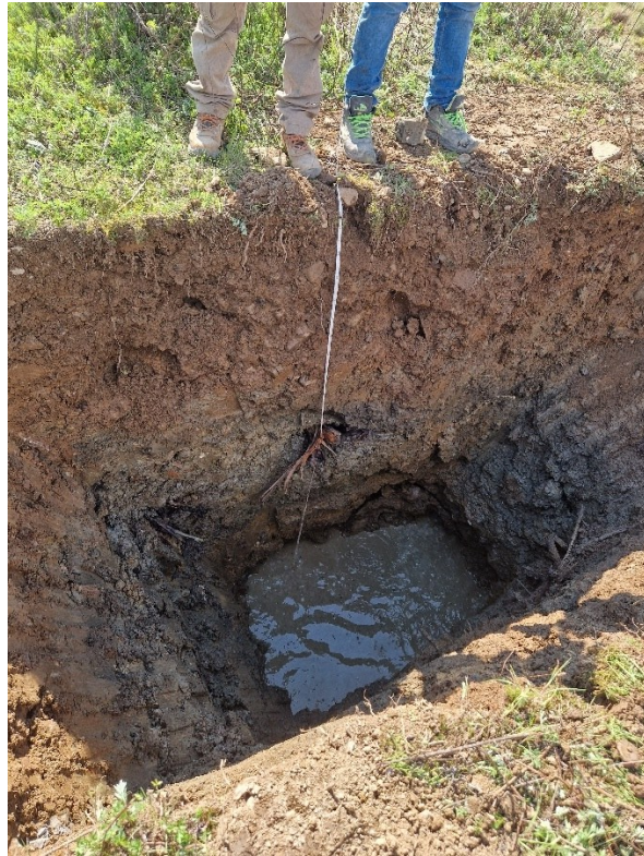
Venuta d'acqua in S10 e misura del livello (stabile a 1.9 m da p.c.)
