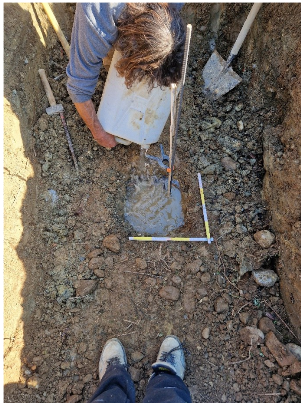
Esecuzione tipo di prova di infiltrazione
