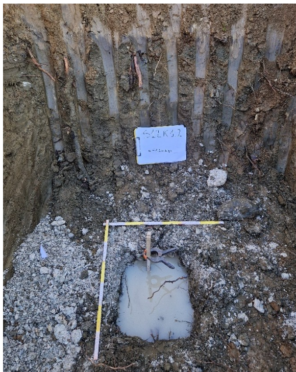
Prova K12 in S12 in corrispondenza di uno strato ricco di calcestruzzo “magro”
