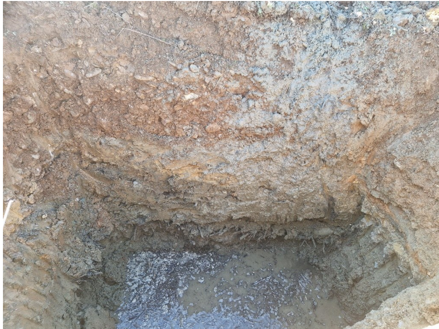
Stratigrafia “tipo” in posizione S2 con strato ricco in legno e tronchi molto persistente nell’area con associato arrivo di acqua dallo strato e dal sottostante costituito da ghiaie in matrice limosa
